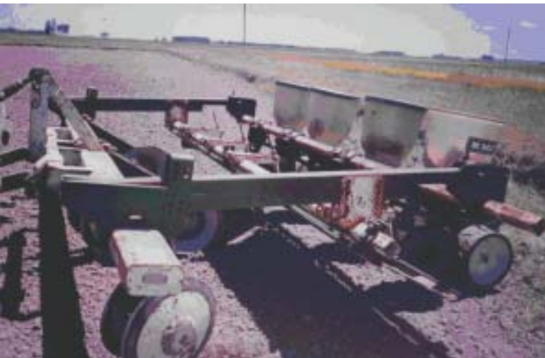
Figura 8. Camalhoieira/semeadora equipada com discos. Embrapa Clima Temperado, 2005.
