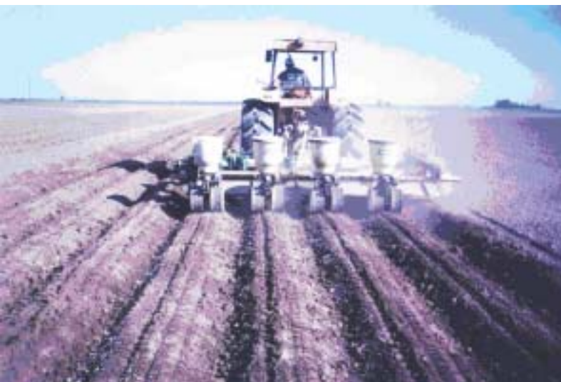
Figura 7. Semeadura de milho no sistema sulco/camalhão com o uso de camalhoieira/semeadora equipada com sulcadores tipo “pés-de-pato”, espaçados de 0,80m. Embrapa Clima Temperado, 2005.
