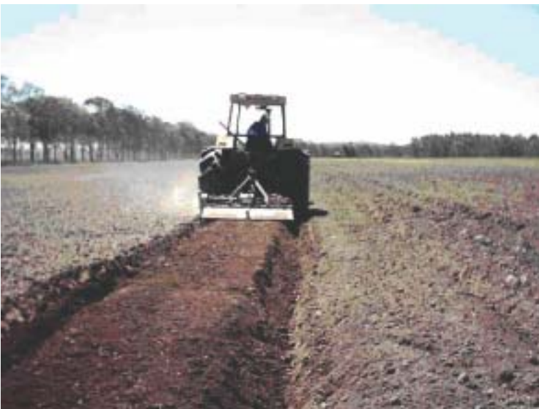
Figura10. Confeção de sulco/camalhão de 1,80m de largura utilizando-se encanteiradora rotativa e formatador de canteiro. Embrapa Clima Temperado, 2004.
