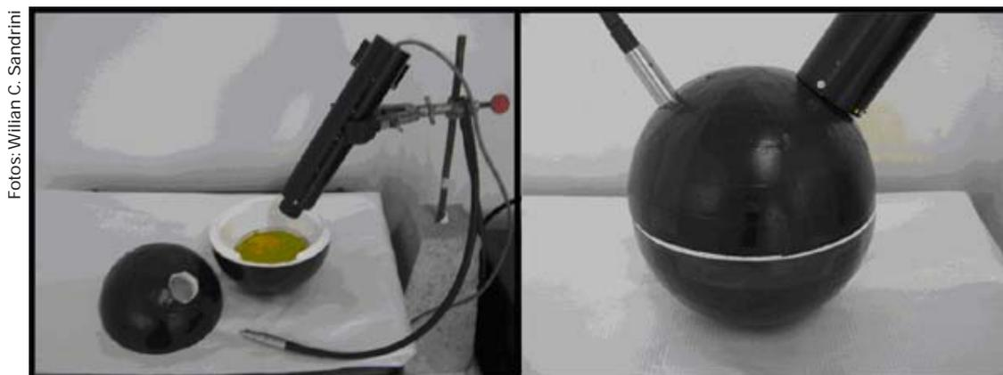
**Figura 1.** Disposição da amostra para efetuar a medição espectrorradiométrica com auxílio da esfera de isopor implementada.
