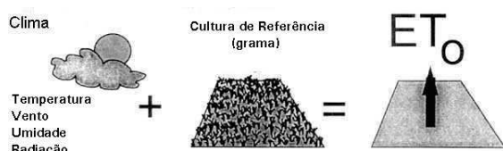
Fig. 1. Esquema representando a evapotranspiração de referência (ET o ) - Adaptado de Allen et al. (1998).
