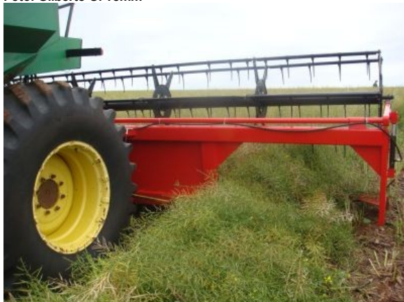
Fig. 10. Vista da abertura lateral traseira da plataforma, para onde as plantas cortadas são levadas pela esteira de borracha, a qual pelo movimento transversal em relação ao sentido do movimento da colhedora, as enleira.
