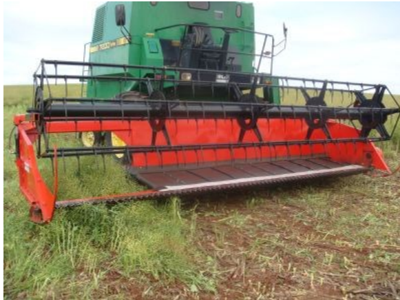
Fig. 9. Plataforma acoplada à colhedora-automotriz, específica para corte-enleiramento de canola (e cereais), fabricada no RS.
