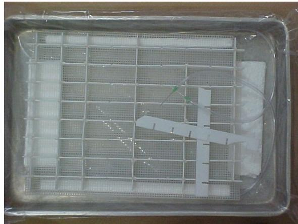
Fig. 2. Bandeja montada, mostrando detalhes de encaixe da grade de plástico, dos tubos e mangueiras para aeração e da colocação de bóias de poliestireno.
