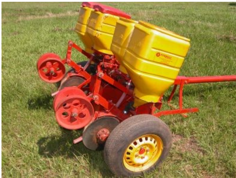
Fig. 1. Semeadora de tração animal para plantio direto, de duas linhas de semeadura modelo Fitarelli nº 14.
