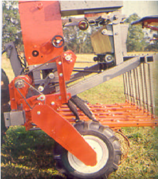
Fig. 2. Semeadora múltipla para plantio direto de experimentos e de progênies.
