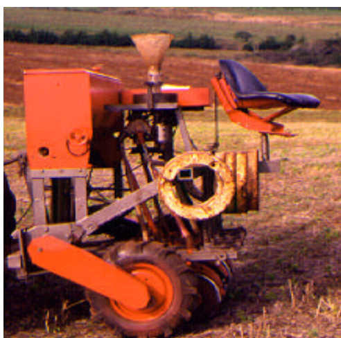
Fig. 1. Semeadora para ensaios de competição de cultivares de cereais de inverno.
