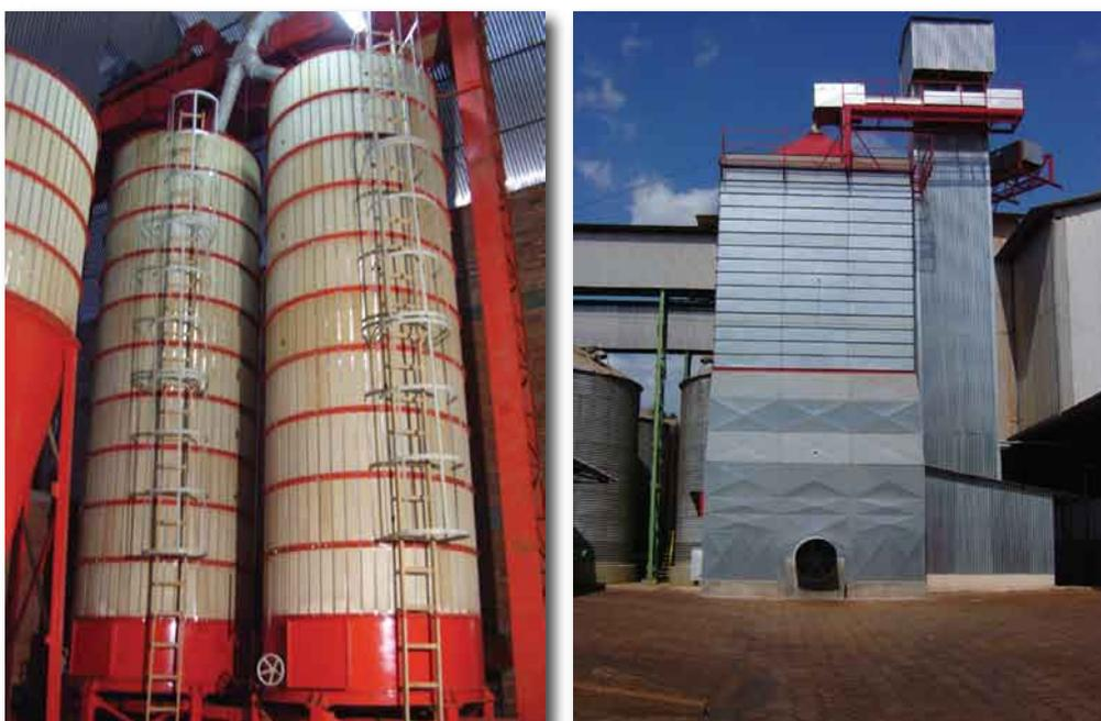
**Fig. 12.** Silo secador estático com secagem radial, à esquerda (foto: J.B. França Neto), e secador intermitente para semente, à direita. Foto: F.C. Krzyzanowski.
