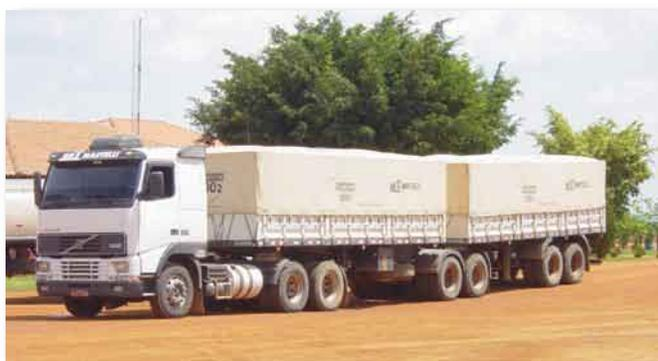
Fig. 16. Caminhão bi-trem, utilizando lona de coloração clara, usado para o transporte de semente de soja. Foto: J.B. França Neto.
