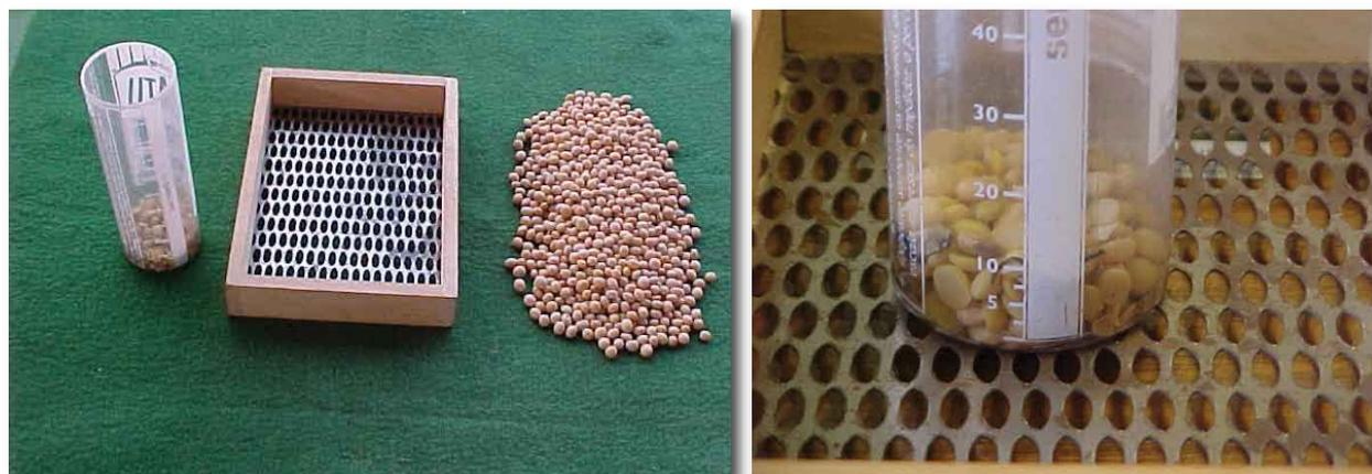
Fig. 18. Copo medidor usado para a determinação do percentual de sementes quebradas (bandinha) de soja durante a colheita. Fotos: F.C. Krzyzanowski.
