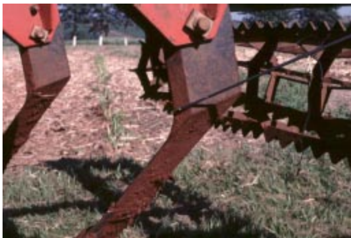
FIG. 24. Características da haste de um escarificador que mobiliza pouco o relevo superficial do solo e, dependendo da regulagem, preserva grande parte dos restos de cultivo sobre o solo. Foto: Danilo Estevão.
