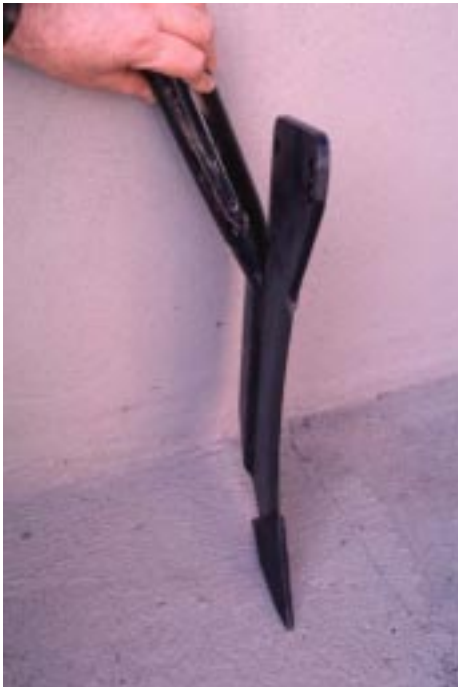
FIG. 23. Facão de lançamento recente pela indústria: face de corte mais fina e com ponteira trocável em função da cultura e solo. Foto: Danilo Estevão.
