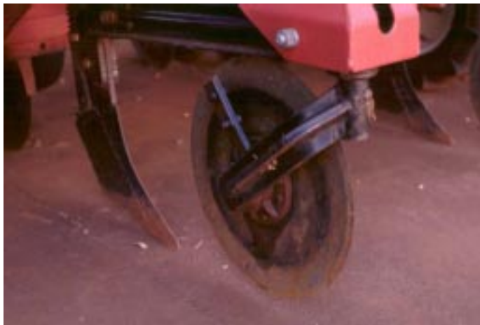
FIG. 21. Facão mais fino e que provoca menos mobilização superficial do solo cultivado.
