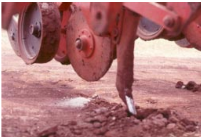
FIG. 17. Semeadora com facão com face de corte larga que mobiliza excessivamente o solo.
