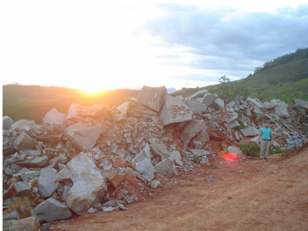
Fig. 34. Excesso de rejeito abandonado na encosta do morro da pedreira vista anteriormente. Fonte: DRM (2004).
