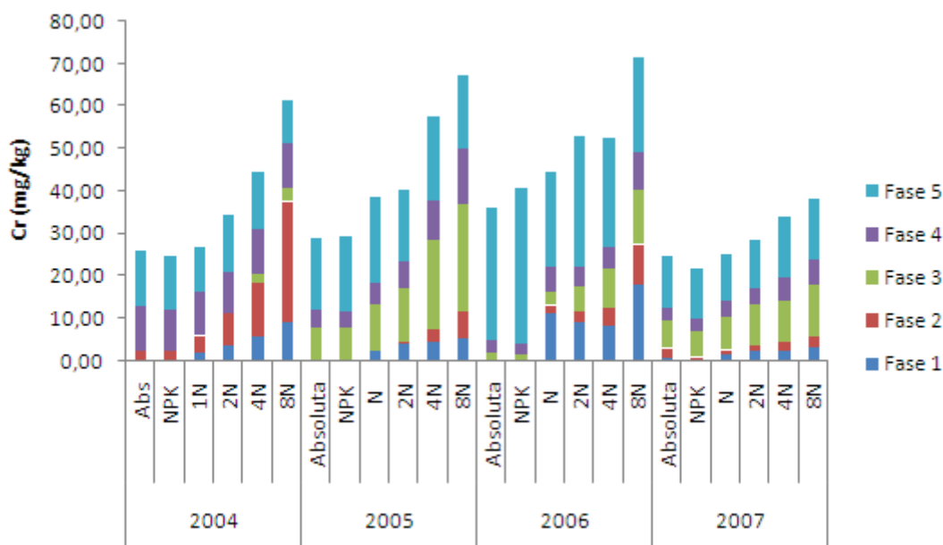
Figura 3. Distribuição de Cr em cinco fases da extração sequencial utilizada nas amostras de solo coletadas (0-20 cm) em experimento com doses de lodo no período de 2004 a 2007
