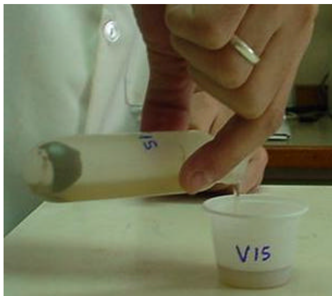
Foto 4. Transferência quantitativa do extrato alcalino do tubo de centrífuga para os copos plásticos.
