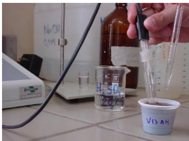
Foto 5. Acidificação do extrato alcalino a pH 1,0 pela adição de solução H_2SO_4 20%.
