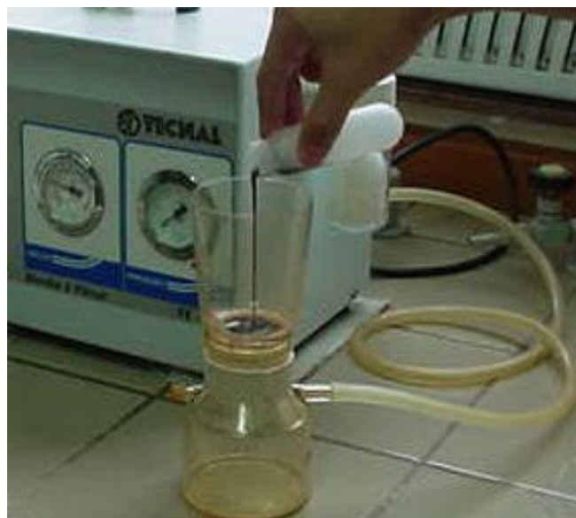
Foto 6. Filtragem a vácuo do extrato acidificado para separação das frações ácido húmico e fúlvico.
