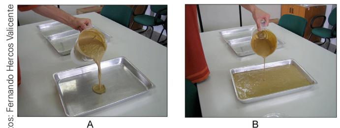
**Figura 6.** Material triturado e misturado com inerte é colocado em bandejas e secas em laboratório com jato de ar dirigido (Figs. 6A e 6B).
