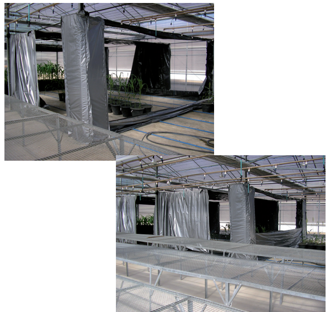
Figura 2. Câmara de controle de fotoperíodo utilizada para induzir o florescimento das linhagens do programa de melhoramento do INRAN (Niger). O sistema de cortinas plásticas é fechado e aberto automaticamente com controle via timers, de maneira a manter o comprimento do dia constante, com incidência de 10 horas de luz por dia.
