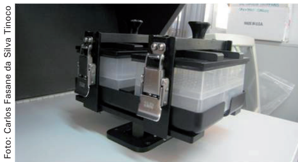
Figura 7. Placas balanceadas fixadas no suporte do triturador.
