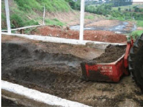
Figura 10. Movimentação do substrato em fermentação após a saturação completa (KONZEN, 2003).
