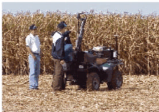
Figura 4. Equipamento automático, equipado com GPS, para amostragem de solo
