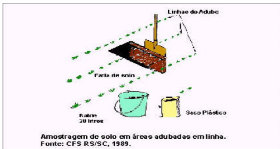
Figura 5. Sistema de amostragem de solos em áreas sob plantio direto adubadas em linhas
