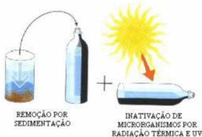
Fig. 8 Esquema do método da desinfecção por radiação solar.
