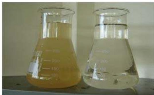
**Fig. 23** Água antes e depois de passar pelo filtro lento de areia.
