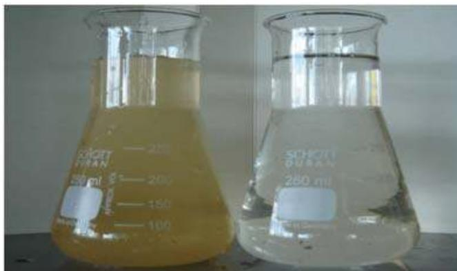
Fig. 26 Água antes e depois de passar pelo sistema.
