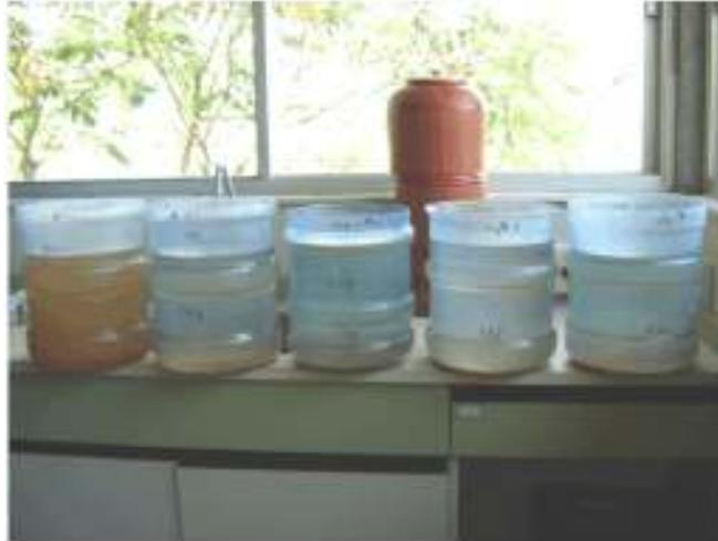
Fig. 20 Teste para verificação da melhor dosagem de semente.
