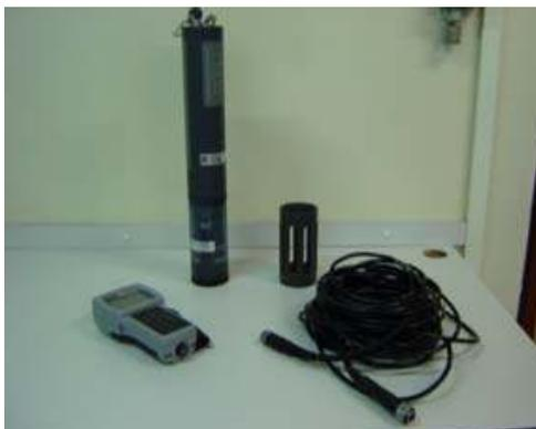
Fig. 17 Sonda Multiparâmetros
