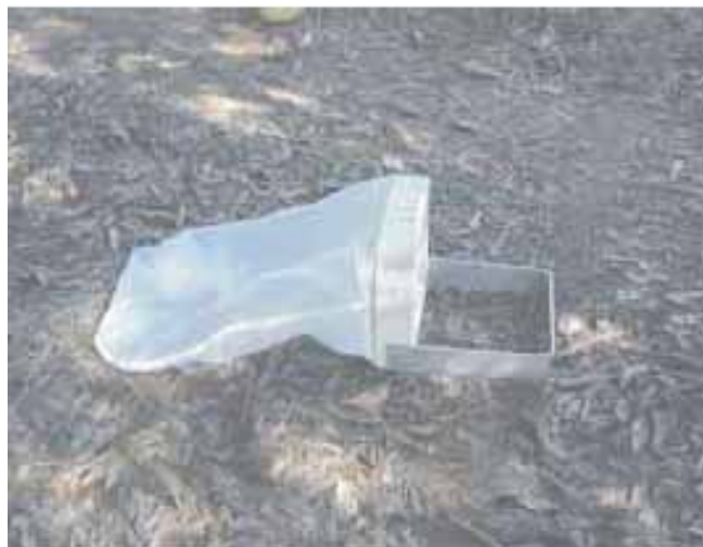
Fig. 8. Coletor Surber, com malha de nylon de 250 micrômetros.
