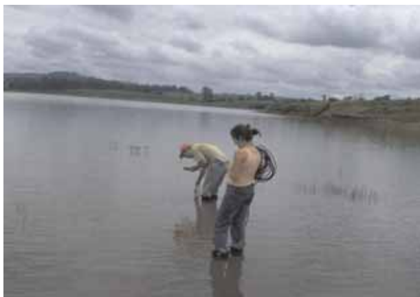
Fig. 7. Medição de parâmetros físicos e químicos de qualidade de água utilizando sonda multiparâmetros.
