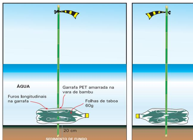
Fig. 2. Coletor com substrato artificial (folhas de taboa), com uso de garrafa PET e varas de bambu para biomonitoramento em viveiros de produção de tilápia.
