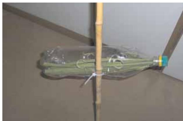
Fig. 3. Detalhe do modelo do coletor com substrato artificial (folhas de *T. dominguensis*).
