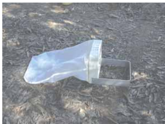
Fig. 1. Coletor Surber, com malha de 250µm.
