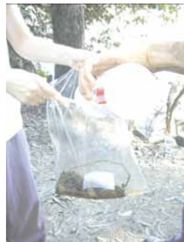
Fig. 4. Fixando a amostra com álcool a 70%.
