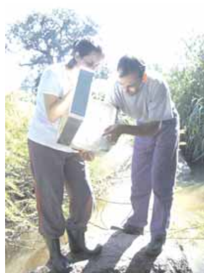
Fig. 3. Transferindo a amostra para o saco plástico.
