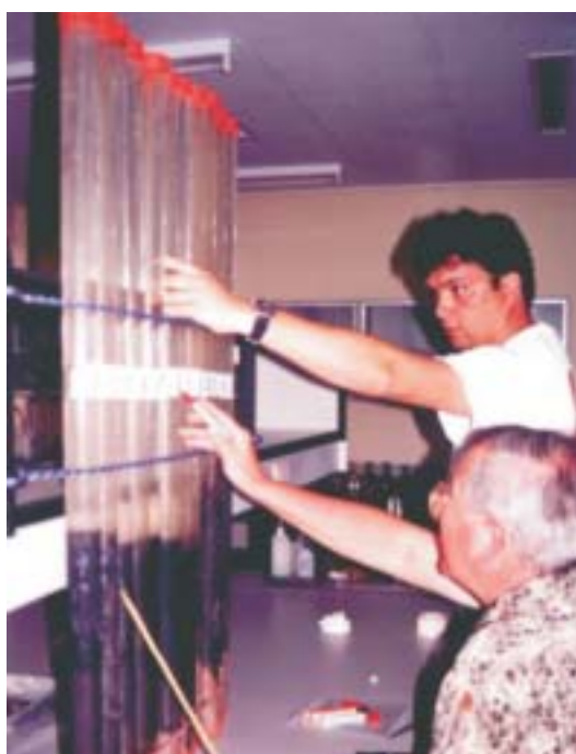
Fig. 5. Verificação da espessura das camadas de sedimentos coletados do fundo de viveiros de piscicultura.
