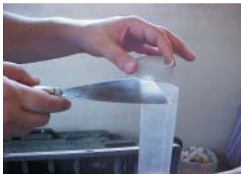
Fig. 4. Detalhe do coletor simplificado (tubo de PVC com 1,5 m de comprimento e 5 cm de diâmetro), do anel de PVC com 2 cm de espessura e 5 cm de diâmetro e da espátula utilizada para segmentar as amostras de sedimento do fundo de viveiros.
