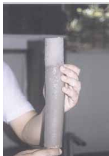
Fig. 9. Detalhe de uma amostra de sedimento de um viveiro de piscicultura em Iquitos, Perú, com fundo constituído predominantemente de areia.
