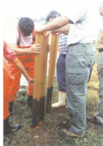
Fig. 7. Detalhe dos tubos de PVC com as amostras e verificação da espessura das camadas de sedimento
