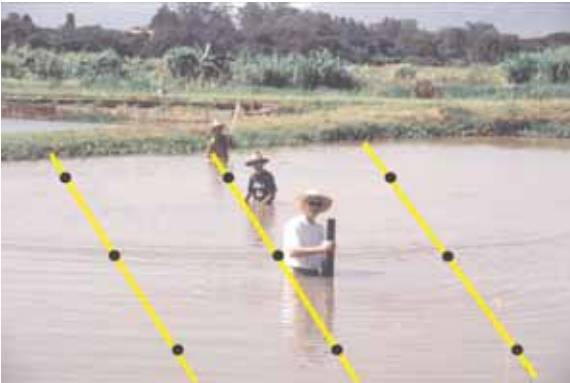
Fig. 3. Representação esquemática dos transeptos (linhas imaginárias) para coleta de sedimentos em um viveiro de aqüicultura.
