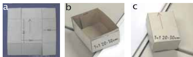
Fig. 1. Caixas de papel usadas para o acondicionamento das amostras indeformadas: a) Caixa de coleta desmontada. b e c) Caixa montada, orientada e identificada.
