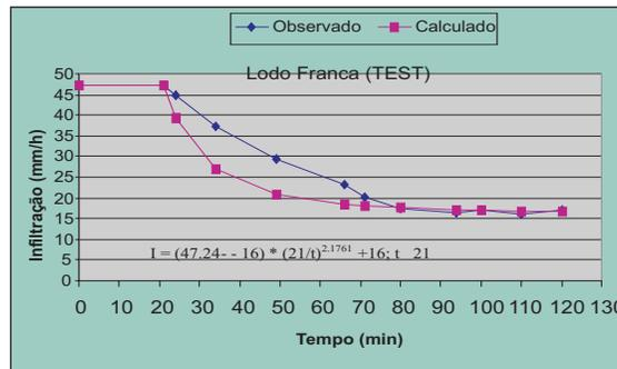
Fig. 5. Taxas de infiltração observada e estimada para o tratamento testemunha sem aplicação de lodo.
