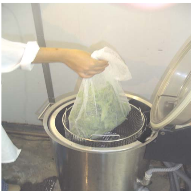
Fig. 4. Processo de centrifugação realizado em centrífuga de aço inoxidável. Embrapa Hortaliças, Brasília-DF, 2004.
