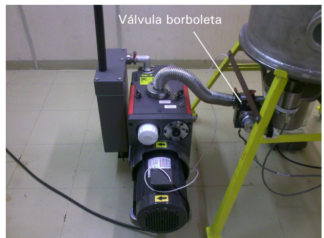
Fig. 3. Bomba de vácuo de duplo estágio marca BocEdwards. Foto: Washington Luiz Esteves Magalhães.
