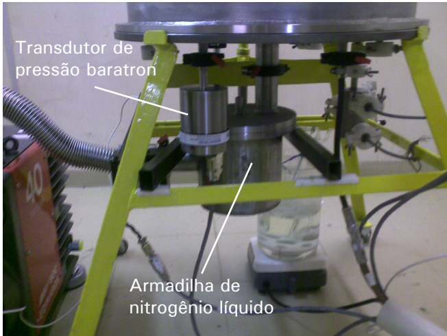
Fig. 4. Armadilha de nitrogênio líquido e o transdutor de pressão baratron. Foto: Washington Luiz Esteves Magalhães.
