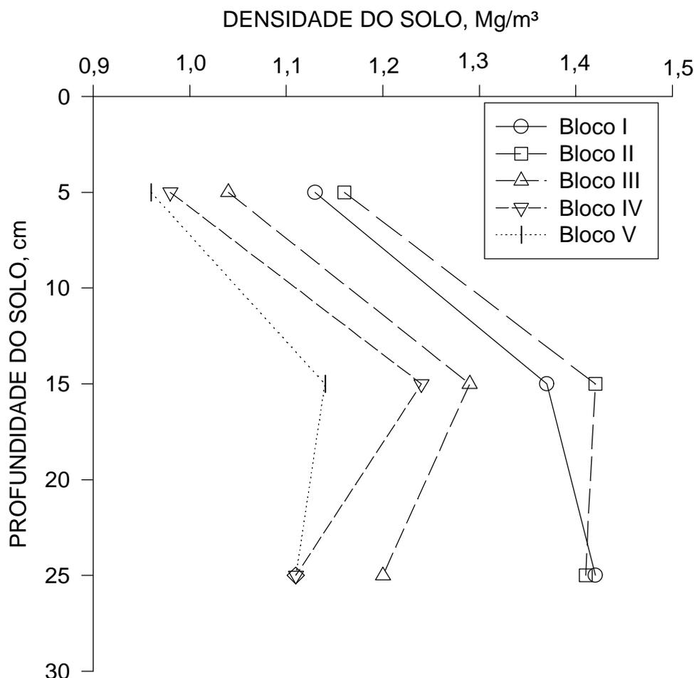
Figura 4. Densidade do solo nos cinco blocos da área experimental, em três profundidades, no ano de 1996, em Ponta Grossa, PR.
