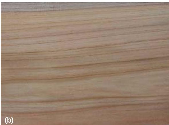
Figura 1. Madeira de *Taxodium distichum*: (a) detalhe de uma peça torneada; (b) aspecto de seção tangencial.
