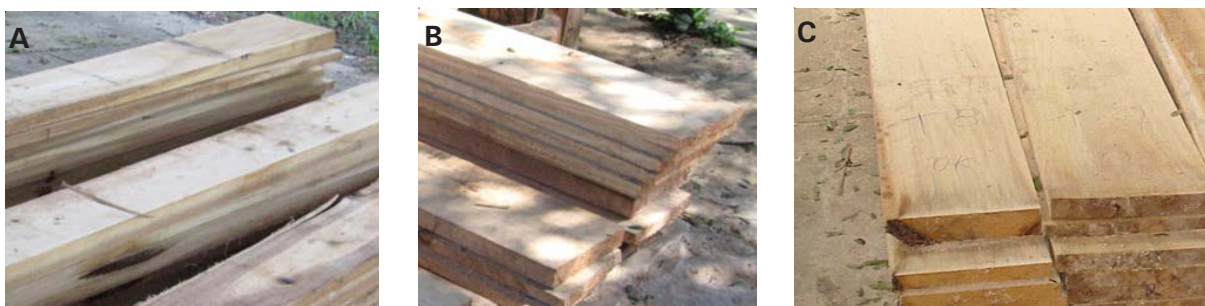
Figura 5. Aspecto do acabamento em madeiras de A) Eucalyptus dunnii , B) Pinus elliottii e C) Araucaria angustifolia serrada com a serraria móvel.
