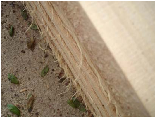
Figura 8. O mal acabamento na lateral das peças de madeira de pinheiro do Paraná, indica que a lâmina de serra fita deveria ter sido travada, afiada ou substituída.
