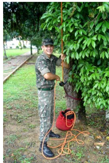
Figura 15. Soldado-coletor de sementes operando o descensor auto-blocante ancorado à árvore, empregando-se fita de nylon com proteção em couro. Foto: Antonio Carlos de Souza Medeiros, 2002.
