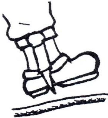
Figura 6. Cuidado para não danificar a corda com o ferrão da espora. Fonte: Segurança... (2002).
