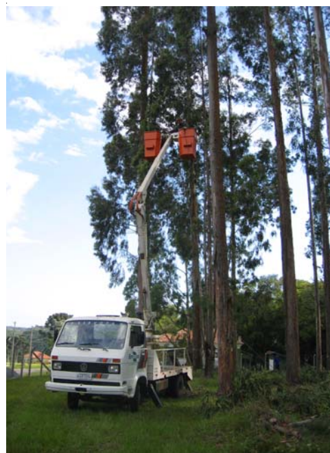
Figura 10. Caminhão dotado de caçamba acoplada à haste telescópica de içamento hidráulico que possibilita fácil acesso à periferia das copas, aonde se concentram os galhos contendo os frutos a serem colhidos. Foto: Paulo Eduardo T. dos Santos.
