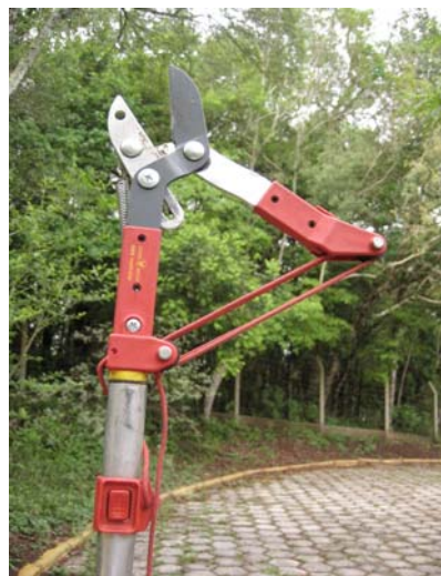
Figura 7. Detalhe da tesoura empregada para o corte de galhos finos de eucalipto durante a colheita de sementes. Foto: Paulo Eduardo T. dos Santos.
