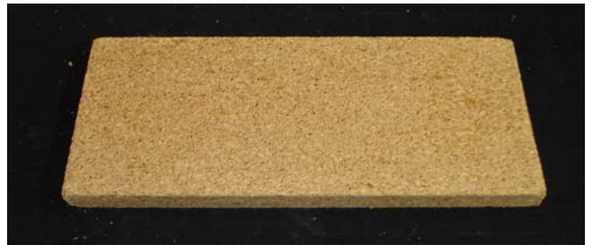
Fig. 3. Painel de aglomerado com dimensões 150 mm x 100 mm x 15 mm.
