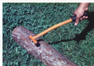
Figura 2 - Martelo para perfuração do tronco
