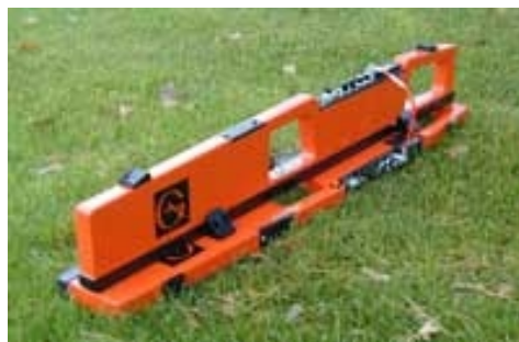
Fig. 2. Sistema de medida de condutividade elétrica do solo por indução eletromagnética, modelo EM-38 (Geonics Limited).
