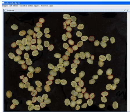
Fig. 25. Grãos classificados pela rede neural treinada através do programa desenvolvido, analisando os coeficientes de Fourier. Grãos normais estão com as bordas em amarelo, quebrados em vermelho.
