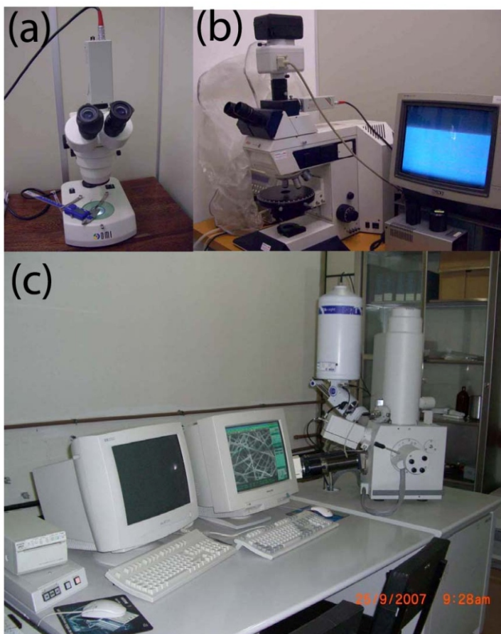
Fig. 1. Equipamentos de microscopia utilizados: (a) Lupa; (b) Microscópio Ótico com Luz Polarizada; (c) © FEG-MEV.
