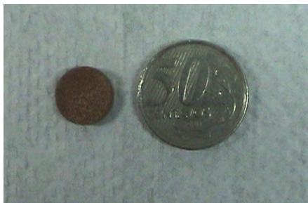
**Fig. 2.** Pastilha de solo em comparação com uma moeda (2,2cm de diâmetro).
