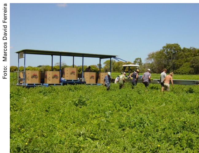
Fig. 3. Equipamento de auxílio com esteira rolante utilizado para colheita de melancia e melão.
