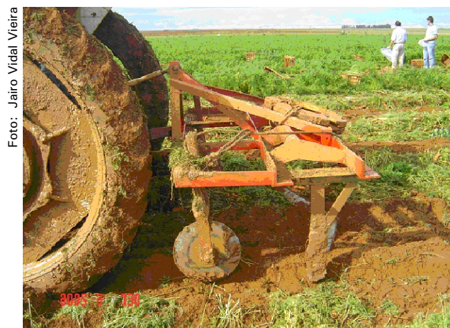
Fig. 1. Lâminas cortantes para colheita de cenoura (Observar lâmina em “V”).
