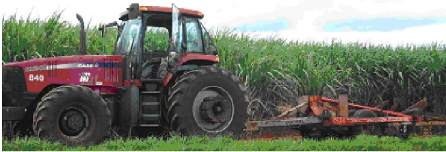
Fig. 1. Implemento subsolador adaptado para medida de condutividade elétrica do solo.
