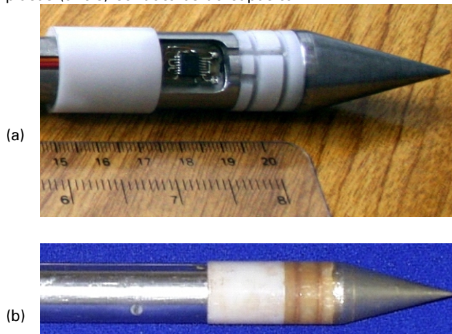
Fig. 2 - (a) Detalhe do circuito eletrônico do sensor de umidade. (b) Montagem final mostrando os anéis condutores próximos à ponta cônica.
