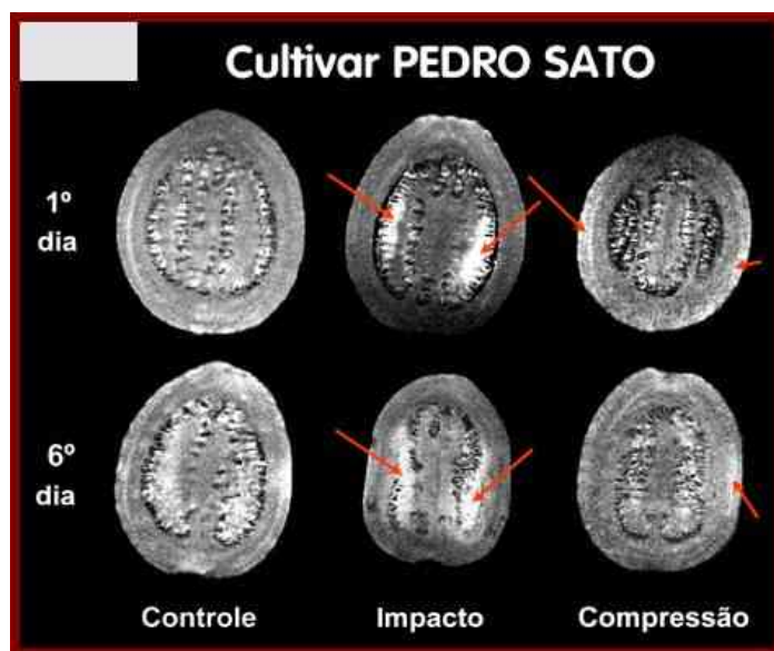
Fig. 4 - Imagens de RMN de goiaba mostrando efeitos de injúrias mecânicas
