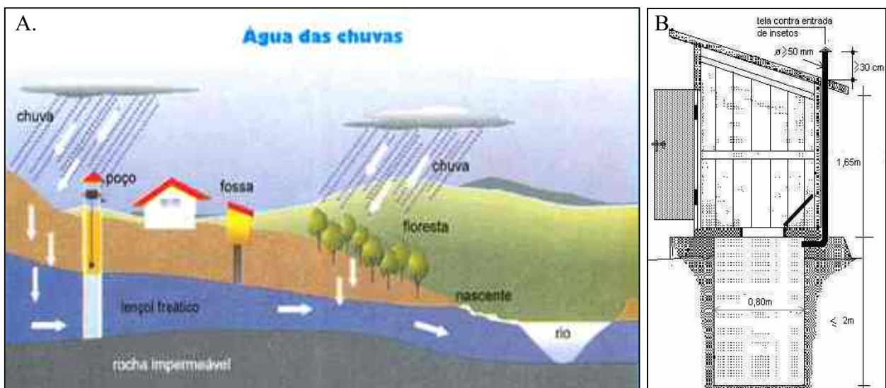
Fig. 1 - A. Fossa rudimentar mostrada em um contexto ambiental. B. Esquema de uma fossa rudimentar
