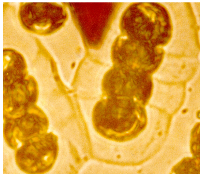
Figura 2 Imagem microscópica da alga S. Panduriforme . A região mais escura é o corpo da alga e a parte transparente a cápsula. O triângulo que aparece invertido na parte superior da imagem é parte do cantilever
