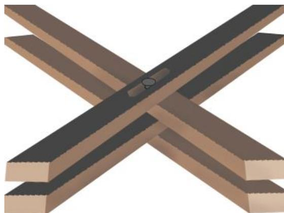
Figura 8. Cruzamento entre elementos numa malha de camada dupla
