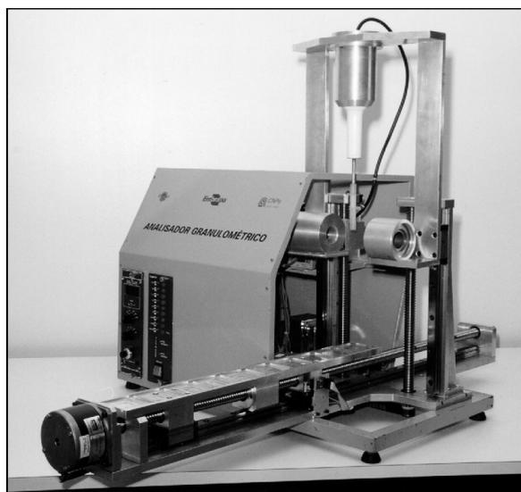
Figura 1 - Foto do protótipo desenvolvido para a análise de 10 amostras.
