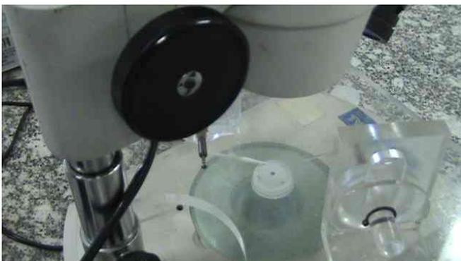
Fig. 2 - Visão geral do sistema micromanipulador com grade porta-amostra. (Créditos: Antônio Pereira de Novaes)
