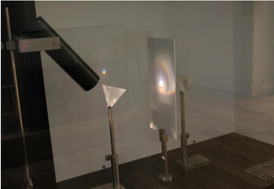
Figura 1: Módulo com a reprodução da Experimentum Crucis de Sir Isaac Newton.
