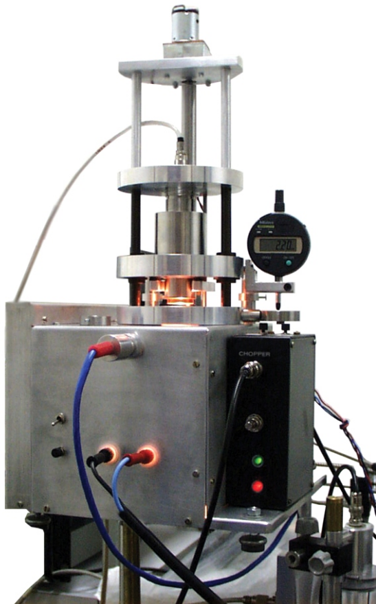
Fig. 1. Protótipo do Medidor Fototérmico de Impurezas no Café em Pó.
