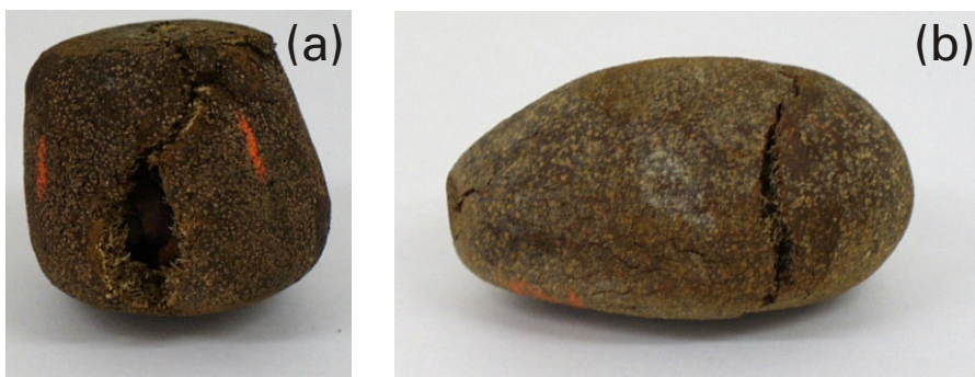
Fig. 3 Frutos de castanha-de-cutia com a casca rompida após compressão longitudinal (a) e após compressão transversal (b).
